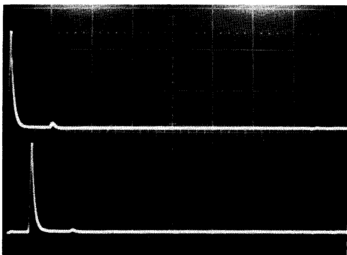
Abb. 5: Kabelende mit Potentiometer mit R = 50\ \Omega abgeschlossen
