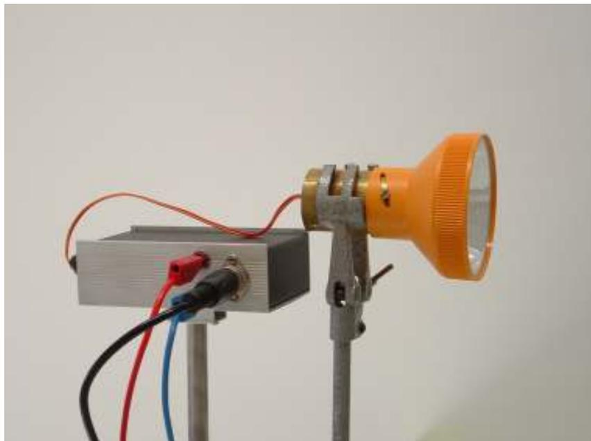
Zur Erzielung einer sehr großen Reichweite kann der Lichtdemodulator auf das Okular eines Fernrohres aufgesetzt werden. Dazu ist am Lichtdemodulator ein Metallring befestigt, der auf das Okular aufgesetzt werden kann.
